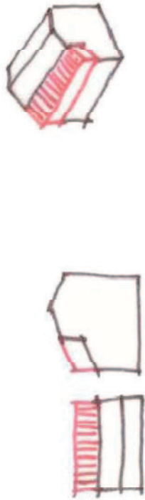
SOPRAELEVAZIONE DI PORZIONE DI FABBRICATO CON PROLUNGAMENTO DELLA FALDA
